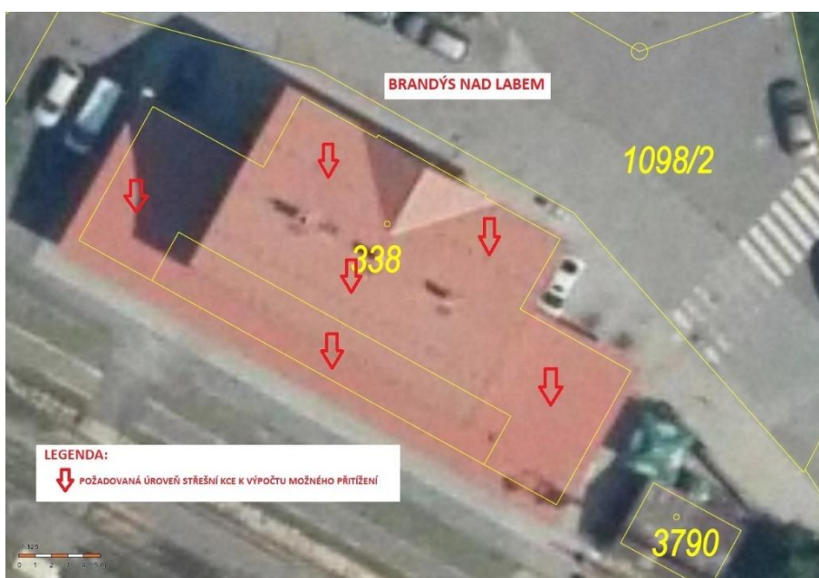
Obr. 2 - Plochy střechy určené k osazení fotovoltaických panelů
